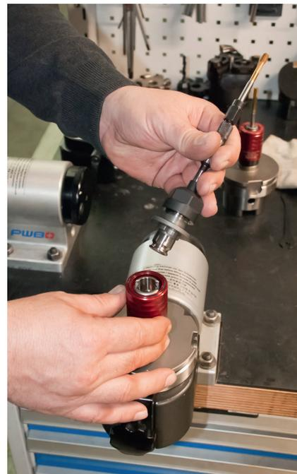
4 Hier das QuickLock-System mit einer Schaftverlängerung am Werkzeugmontageplatz. Der hochpräzise und mit Spannzangen ausgerüstete EM-Z-Einsatz lässt sich werkzeuglos wechseln
