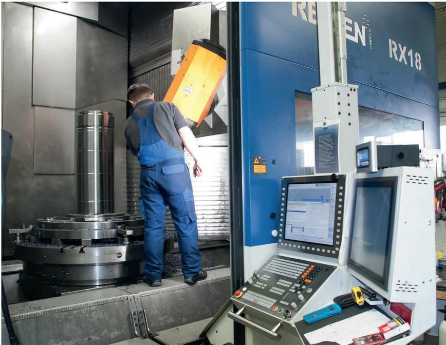
2 Fräsen, Drehen und Gewinden in einer Aufspannung: Das 5-Achs-Bearbeitungszentrum Reiden RX 18 zählt zu den Flaggschiffen bei Wolf. Auch hier kommt das QuickLock-System zum Einsatz (© Emuge-Franken/Wolfgang Bahle)
