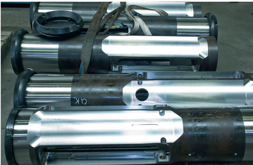
3 Diese Komponenten eines Bohrgestänges für die Ölindustrie lassen ahnen, wie positiv sich eine effiziente Gewindebearbeitung inklusive optimalem Werkzeugwechsel auf die Gesamt-Kostenbilanz bei Wolf auswirkt (© Emuge-Franken/Wolfgang Bahle)
